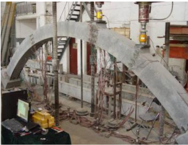
(d) Concrete box arch (for comparison)
